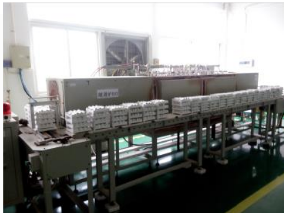
02 隧道 Tunnel Kiln
