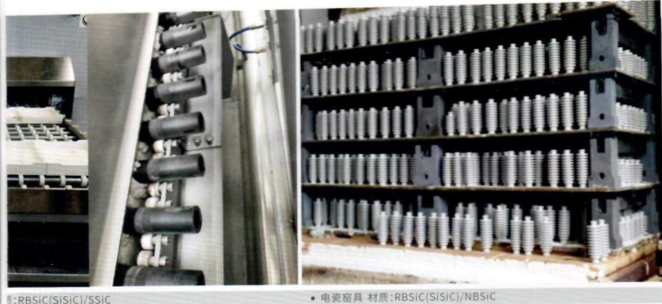
• 电瓷窑具 材质:RBSiC(SiSiC)/NBSiC
