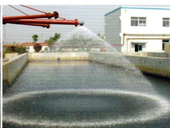
• 喷淋试验平台使客户能够根据数据选择喷嘴参数，并检验喷嘴的喷淋效果。
