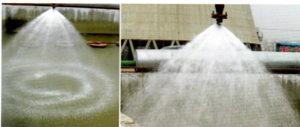
● 喷淋试验平台使客户能够根据数据选择喷嘴参数，并检验喷嘴的喷淋效果。
