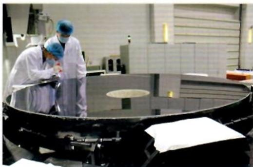
高分辨率空间遥感光学系统核心部件-非球面反射镜 材质: RBSiC(SiSiC)/SSiC
