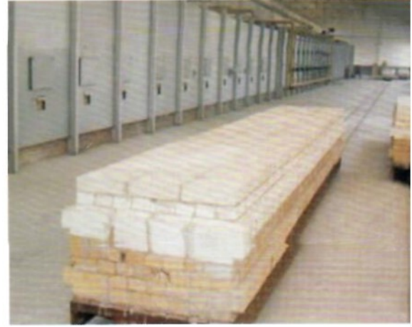
百米长的环保型高温燃气隧道窑
