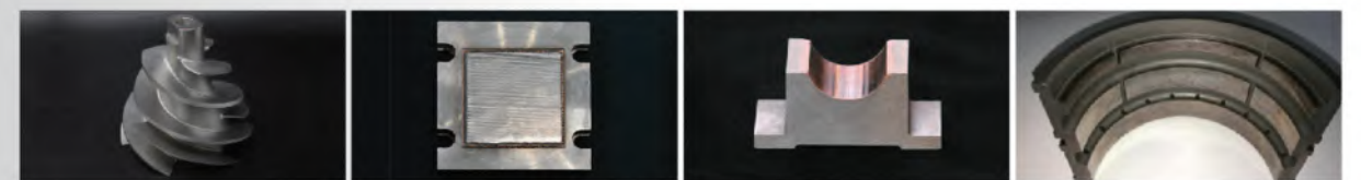
螺旋叶轮 | 材料:17-4PH不锈钢 成形设备:LMDH600S
