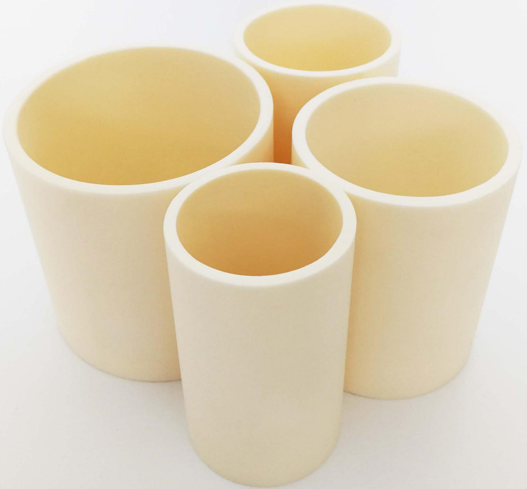
炉管的用途是作为各种实验电炉的内衬，主要是将发热元件与被烧试物质隔开、封闭加热区和放置被烧试物质。炉管应用范围广泛，涉及各行各业高温试验分析仪器设备如：煤炭实验分析仪器设备、冶金粉料实验分析仪器设备、化学玻璃行业实验分析仪器设备等。其最大特点是:在高温下耐腐蚀，抗氧化，防渗漏，真空性好。管壁厚度均匀,直线度好,公差小，高度绝缘，适合于1650度以下使用。
